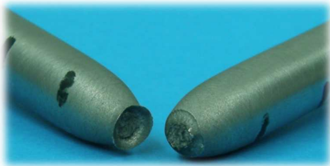
Płaszczyzny poślizgu o kącie \alpha = 45^\circ
